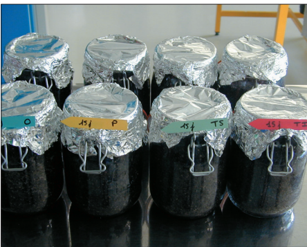
Test de laboratoire in vivo . Les bocaux contiennent, de gauche à droite : du terreau infecté en présence de déchets d'oignon (« O »), de poireau (« P »), du terreau stérilisé (« TS »), témoin sain, ou inoculé avec P. ultimum (« TI », témoin infecté). (ph. I. André)
